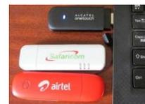
下の写真: インターネット接続用のモデム。携帯電話のネットワークがあるところで、スピードは遅いながら接続してメールの送受信ができる。真ん中がサファリコム社。下がエアテル社のもので、ケニアでもマラウイでも、SIM を入れ替えるだけで使える。上が、最近、スタッフが見つけてくれた「SIM フリー」のモデムで、通信会社に縛られないタイプ。マラウイでも使える。
